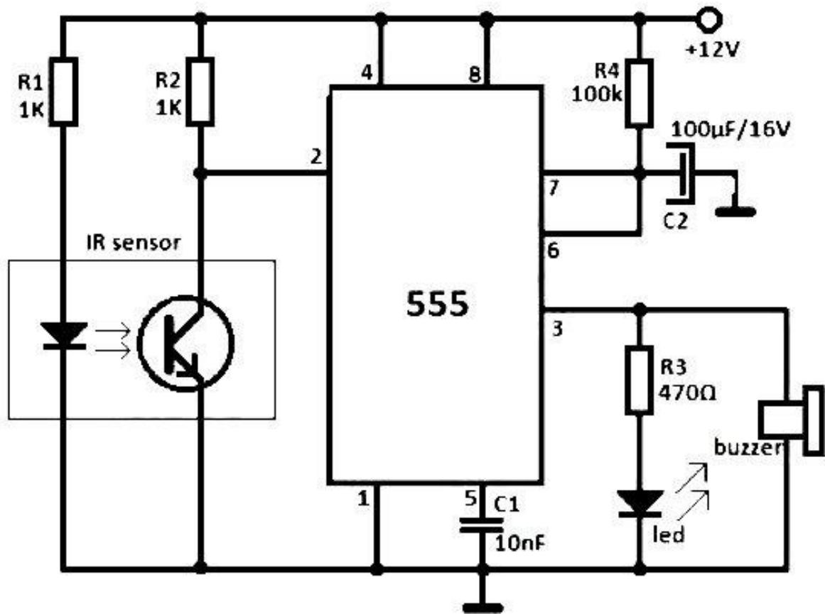
Na slici iznad prikazana je shema jednostavnog infracrvenog senzora koji omogućava signaliziranje pokreta, približavanja nečemu.
